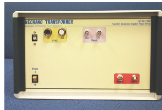
例1) 30倍の電圧増幅器 *信号発生機能内蔵 *4チャンネルまで同期可能
